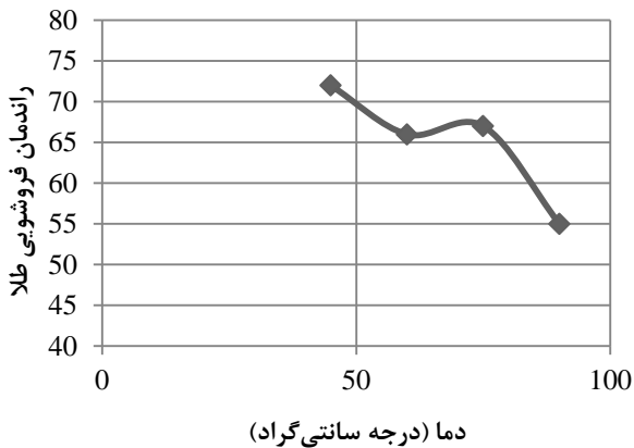
شکل ۱۱- نمودار تاثیر دما بر راندمان فروشویی طلا در مرحله اکسیداسیون (تحت شرایط ثابت غلظت سولفات آهن (۱۱ گرم بر لیتر)، زمان (۸ ساعت)، درصد جامد پالپ (۲۵ درصد)، pH برابر با ۱)
