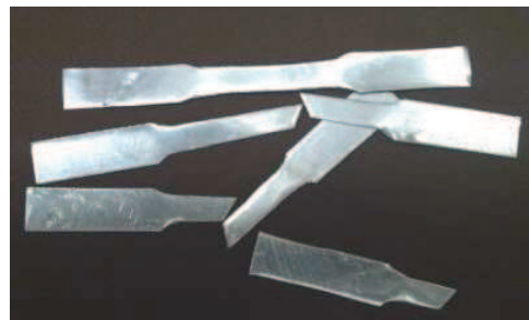
شکل (۳): هندسه و نمونه مورد آزمایش در تست کشش
