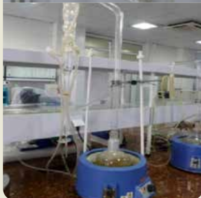
شکل ۱۳- استخراج اسانس آویشن به وسیله دستگاه کلونجر در آزمایشگاه
